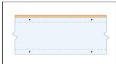
**Figure 3a : Vue en bout d'un espacement de 600 mm, en plaçant la plaque de plâtre régulière de 15,8 mm (5/8 po) sur le dessus de la semelle inférieure de la solive en I**
